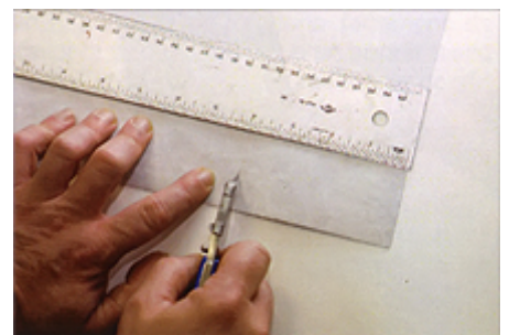
2) ตัดผ่านกระดาษทับหลัง ระวังอย่าให้เข้าเนื้อสกรีนฟลิคด้านล่าง
